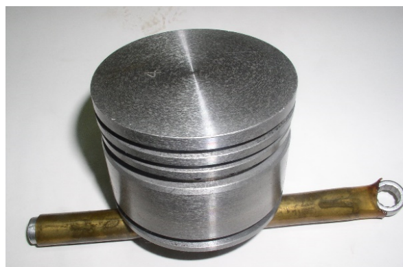
Rys. 2. Tłok AlSi7/SiC po badaniu zatarcia
