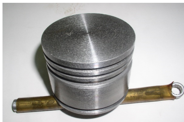
Rys. 2. Tłok ALSi7/SiC po badaniu zatarcia
